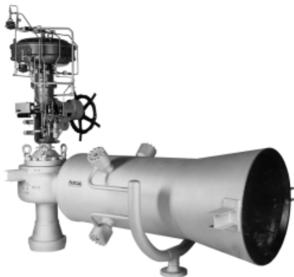
Valvola Limiphon riduttrice / desurriscaldatrice 1-9445 con corpo ad angolo con ingresso inferiore e camera di iniezione con ugelli multipli a molla tipo LVM saldata a valle.
