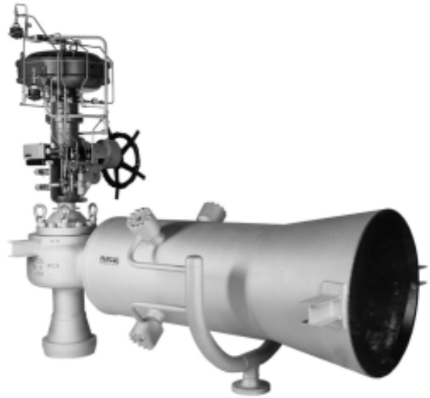
Valvola Limiphon riduttrice / desurriscaldatrice 1-9445 con corpo ad angolo con ingresso inferiore e camera di iniezione con ugelli multipli a molla tipo LVM saldata a valle.
