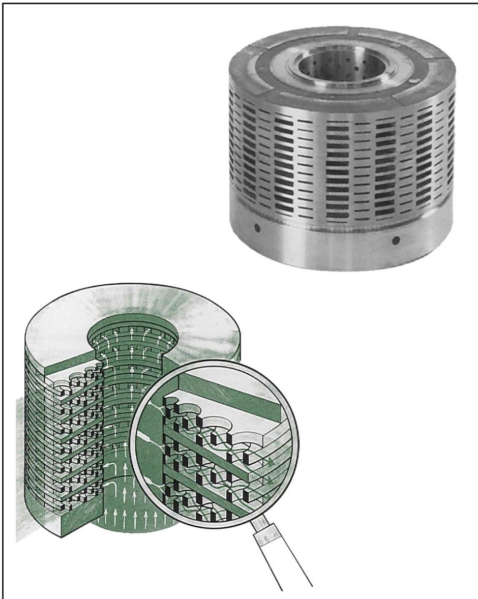
Fig. 12 Trim di valvole di regolazione tipo LIMIPHON del tipo universale multistage/multipath con pacco di dischi a labirinto. I passaggi del fluido sono ottenuti mediante la sovrapposizione dei dischi opportunamente forati e orientati fra di loro.
