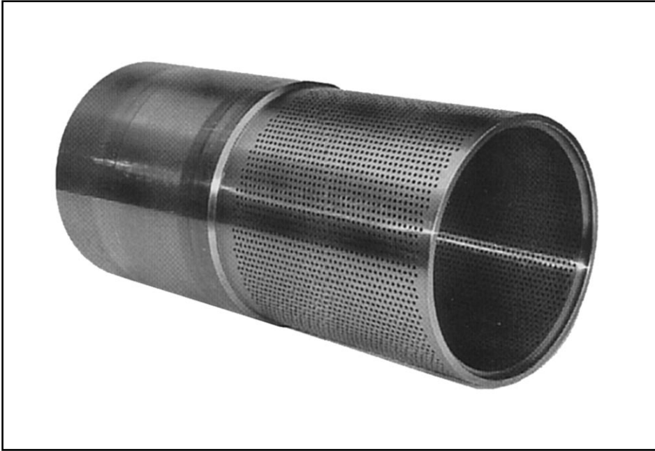
Fig. 10 Gabbia singola tipo GBR - La riduzione di rumorosità è ottenuta mediante l'esecuzione di un numero elevatissimo di fori di diametro molto piccolo (2÷4 mm) - Attenuazione acustica fino a 15 dB.
